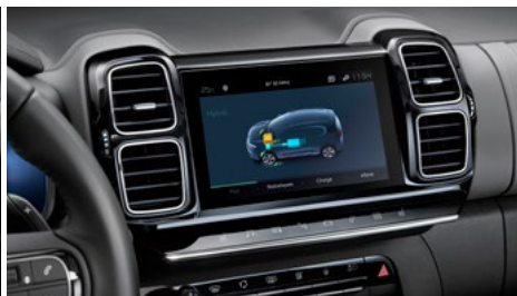
Tok energie: zobrazuje fungovanie hybridnej technológie
